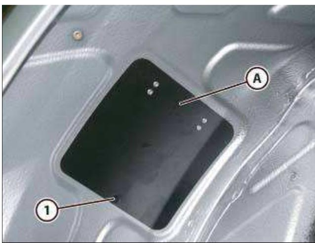
● 安装油箱盖板(A)并用螺钉(1)固定。
