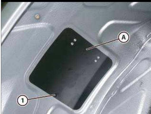
► 从左后车轮室开始, 拆卸燃油油箱盖板(A), 松开将部件固定至车身的螺钉(1)。
